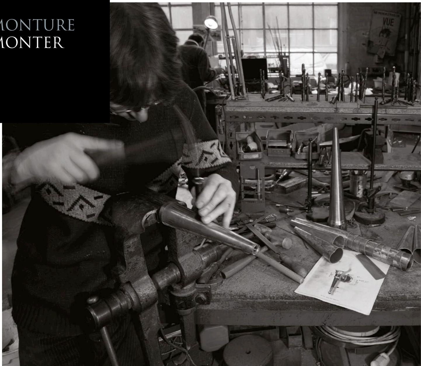
Le Monteur construit et assemble les pièces par brasure ou par monture à froid. Il effectue les interventions de pliage, de cintrage et travaille également sur plans.
